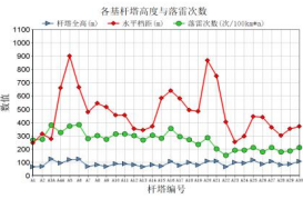
图 1-2 全线杆塔高度与落雷次数
